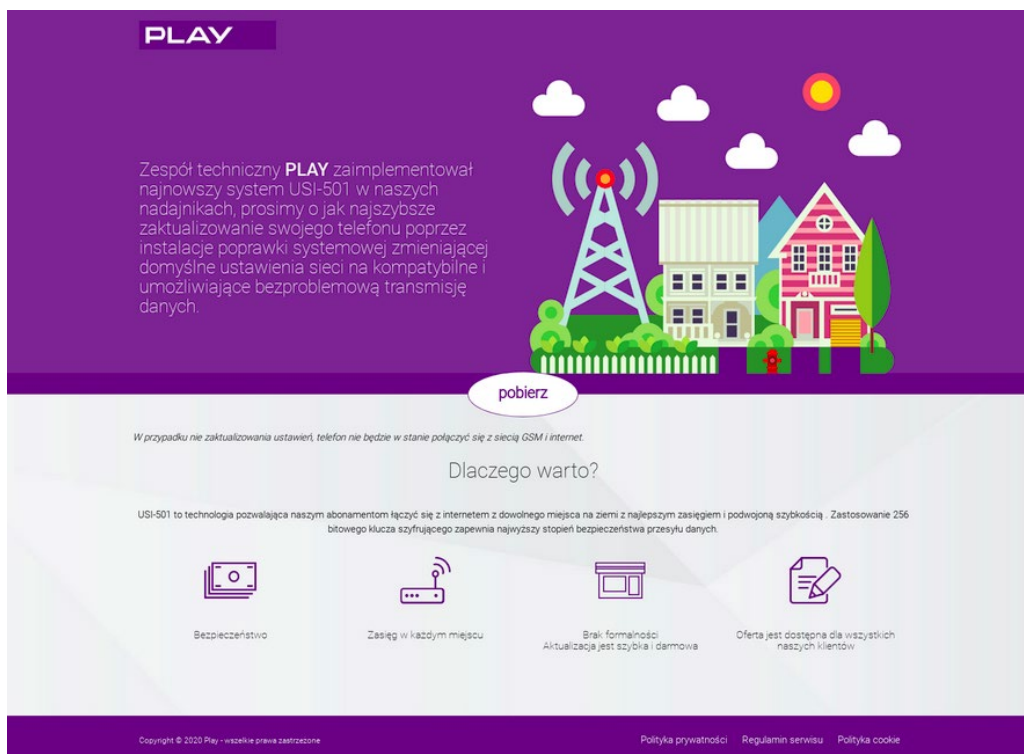
Rys. 50. Fałszywa strona podszywająca się pod operatora sieci komórkowej Play, nakłaniająca do instalacji poprawki systemowej – w rzeczywistości złośliwego oprogramowania.
